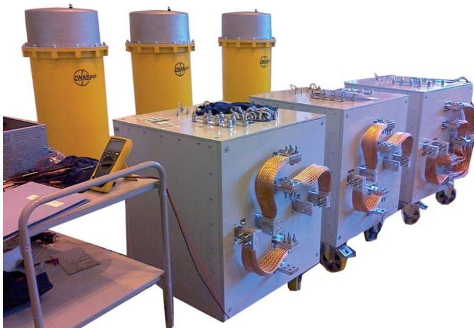
Комплект для испытаний высокотоковых трехфазных систем с трансформаторами TW25 и TRP10
