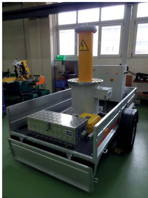
Система UP6J 100 AC - 130 DC, смонтированная на прицепе (выпрямитель монтируется на верхнем зажиме трансформатора)
