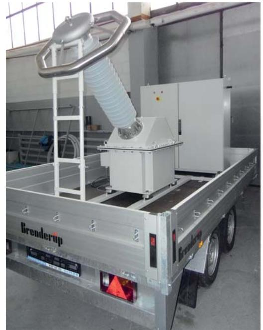
Система UP20-185 (20 кВА, 185 кВ AC), смонтированная на прицепе
