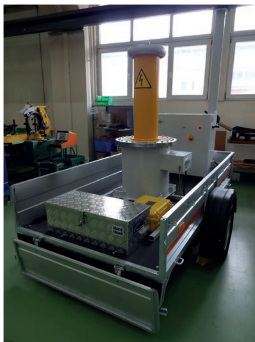
Układ UP6J 100AC - 130DC zainstalowany na przyczepie (prostownik montowany jest na górnym zacisku transformatora)
