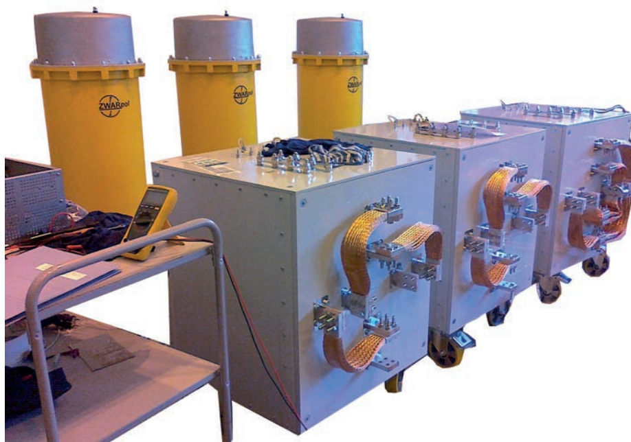
Zestaw do prób wieloprądowych układów trójfazowych z transformatorem TW25 i TRP10
