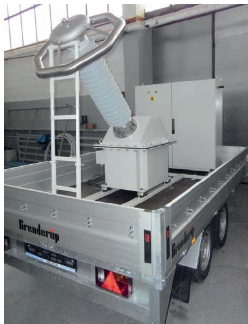
Układ UP20-185 (20kVA, 185kV AC) zainstalowany na przyczepie
