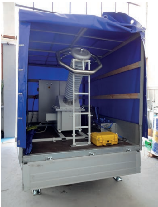
Układ UP20-185 (20kVA, 185kV AC) zainstalowany na przyczepie
